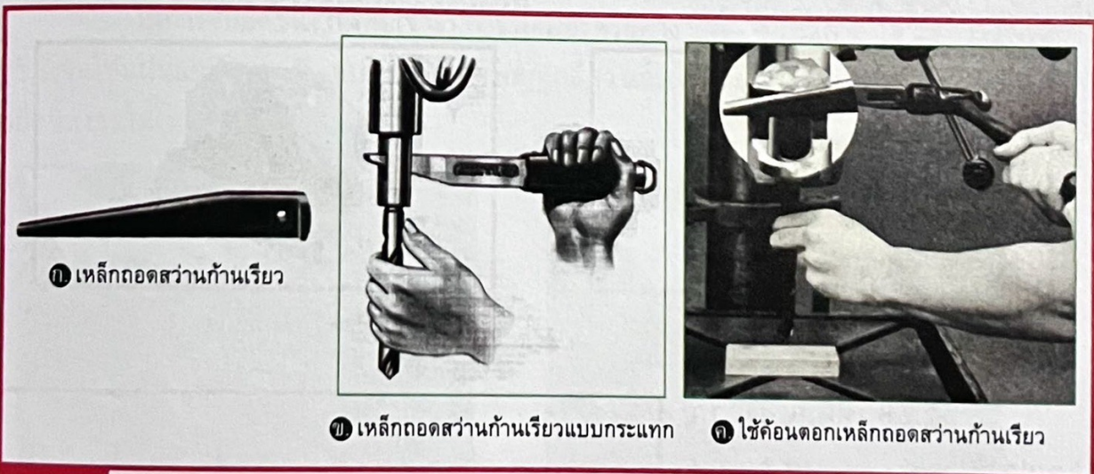
รูปที่ 7.8 เหล็กถอดสว่านก้านเรียวและวิธีการใช้
