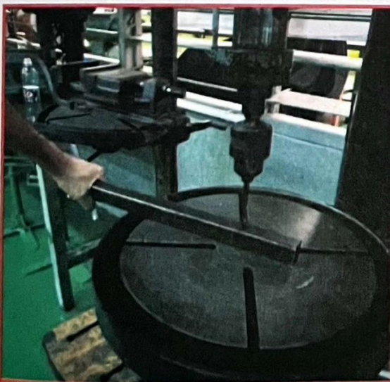
รูปที่ 7.32 ผู้ปฏิบัติงานใช้มือจับยึดชิ้นงานอาจเกิดอุบัติเหตุได้
