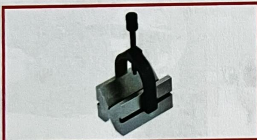
รูปที่ 7.11 จับยึดงานบนวี-บล็อก โดยมีแคลมป์ยึด
