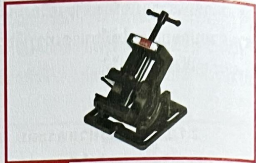
รูปที่ 7.10 ปากกาจับชิ้นงานเจาะแบบเอียงมุม
